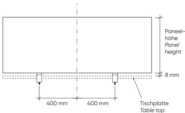
Panel mit Tischklemmen zum Befestigen an Tischen. Beide Tischklemmen sind am innenliegenden Funktionsrahmen des Paneels frei verschiebbar / positionierbar.
