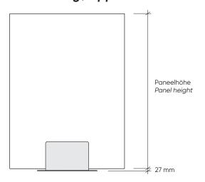
Paneel mit Standfuß zum Aufstellen auf den Boden. Anbindung mit folgenden Paneelgrößen (cm) möglich: 70x160 / 100x160 / 120x160 / 100x180 / 120x180
