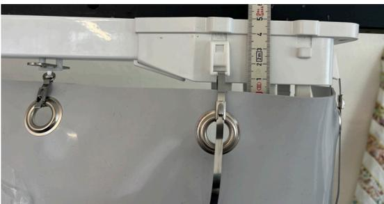
Fixer le NoiseBlocker ou le NoiseSilencer au clip moteur à l'aide d'un serre-câble.
